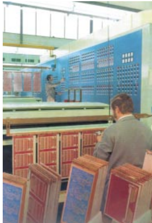
Ab 1971 wurde die Leiterplattenfertigung ausgebaut. Ihr Kernstück war eine vollautomatische Galvanisierungsanlage. Die Leiterplatten wurden hier mit einer Metallschicht versehen.
